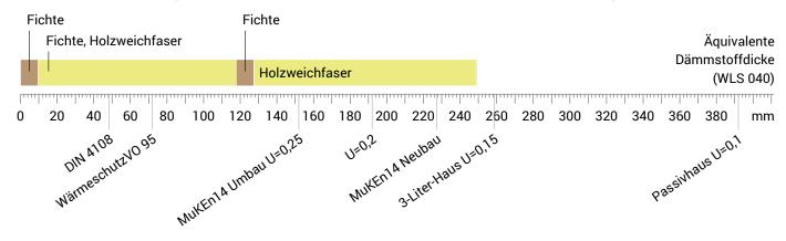
Raumluft: 20,0°C / 50% Dicke: 45,4 cm Außenluft: -5,0°C / 80% sd-Wert: 5,5 m Gewicht: 99 kg/m² Oberflächentemp.: 18,9°C / -4,8°C Trocknungsreserve: 1414 g/m²a Wärmekapazität: 83 kJ/m²K
